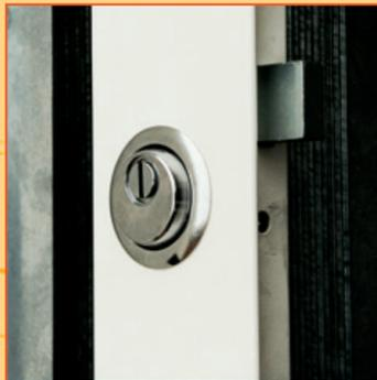
**SERRATURA:** la serratura (brevetto V&P) è triplice azionata da maniglia 8 e bloccata da cilindro a profilo europeo. La serratura manovra due aste a catenaccio che, passando tra le piastre forate, ricavate sulle parti estreme dei montanti centrali dell'anta, prima d'inserirsi nell'occhiello superiore e inferiore assicurano una chiusura stabile e sicura.
