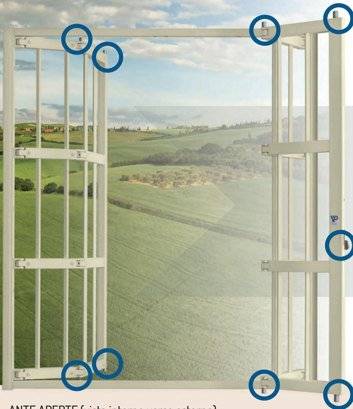
**BIG** è dotata di una serratura di grande sicurezza con 3 punti di chiusura, azionata da un cilindro europeo, con corsa dei catenacci (Ø mm. 16) di mm. 30 e gancio centrale in acciaio (spessore mm. 10).
